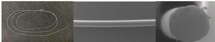
図4 ラット生体内の分解試験 1) ラット皮下埋植糸の引張強さと破断伸びの変化
